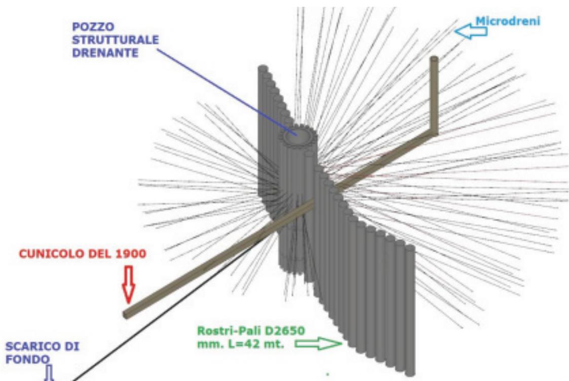
Sono state realizzate diverse opere strutturali per affrontare la situazione, tra cui un pozzo strutturale di grande diametro con una raggiera di aste drenanti e una paratia di pali di notevole diametro (2500 mm). Queste strutture sono progettate per sopportare le sollecitazioni del terreno e si adattano agli spostamenti naturali della frana, consentendo un'azione di compressione progressiva sulla barriera creata fino al raggiungimento di una condizione di stasi.
