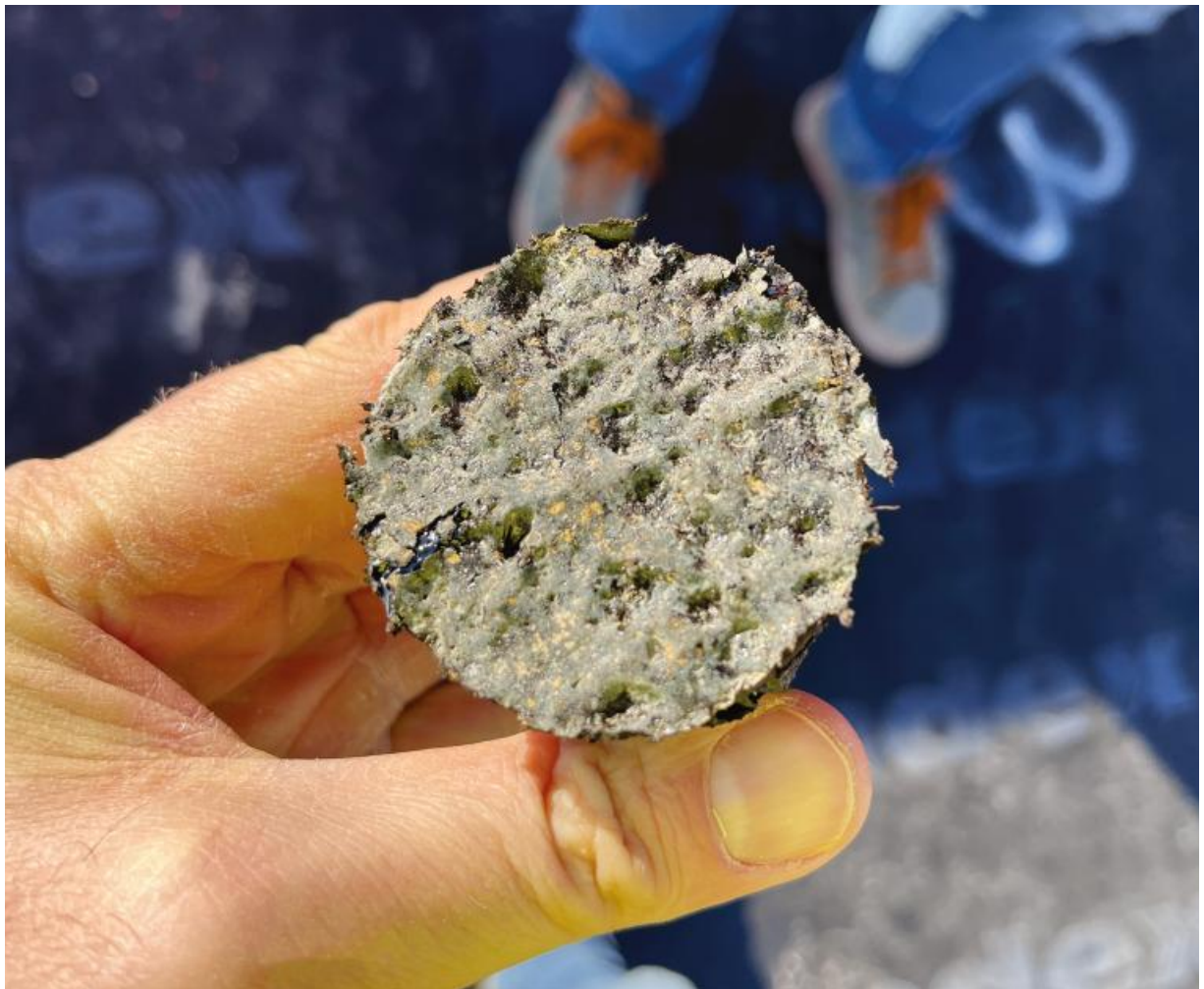
Foto 1: lattime e irregolarità superficiale riducono drasticamente i valori di resistenza allo strappo
